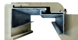
A) obklad ocelové zárubně B) ocelová zárubeň C) hliníková výstuha D) těsnění
